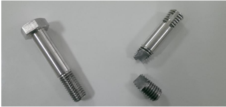
Şekil 3.36 Cıvata Test Numunesi (Test Öncesi ve Sonrası)
