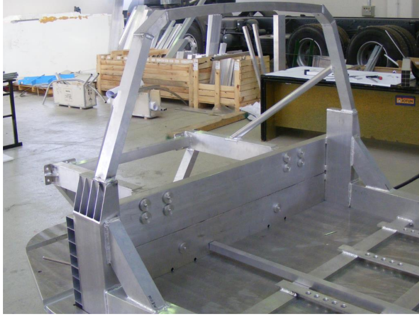
Şekil 5.23 B Sütunu Montajı
