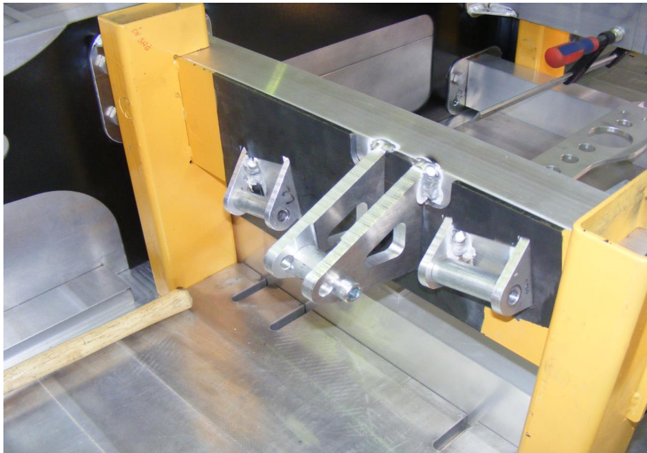
Şekil 5.15 Ön Süspansiyon Bağlantılarının Montajı
