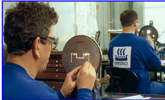
Şekil 1.21 Tel Erozyon yöntemi ile ekstrüzyon kalıbının üretimi [12].
