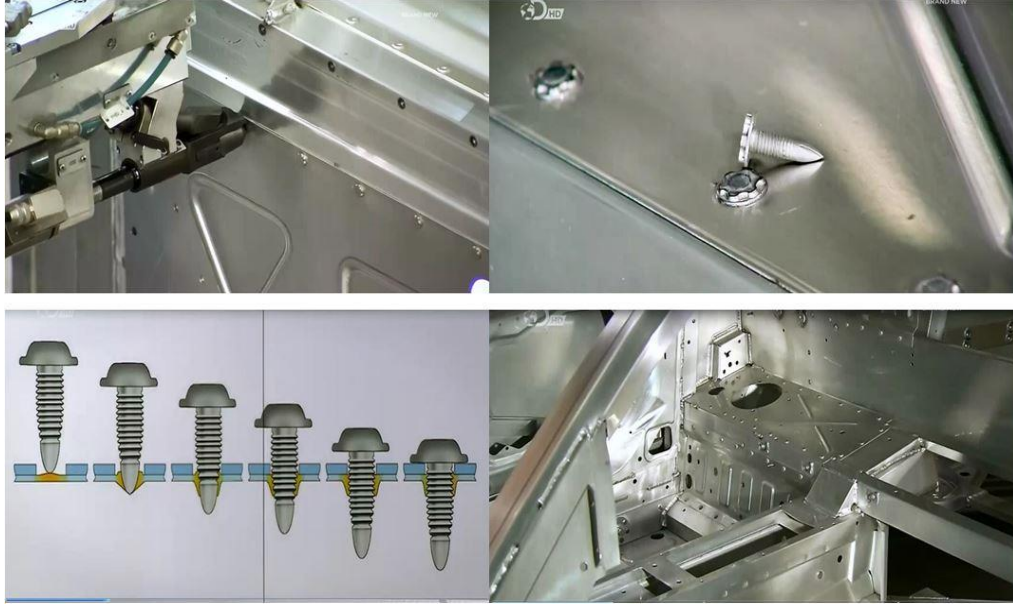
Şekil 1.44 Audi R8 perçin civata teknolojisi
