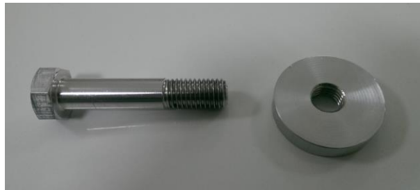
Şekil 2.45 Modüler montajda kullanılacak cıvata ve basma plakası
