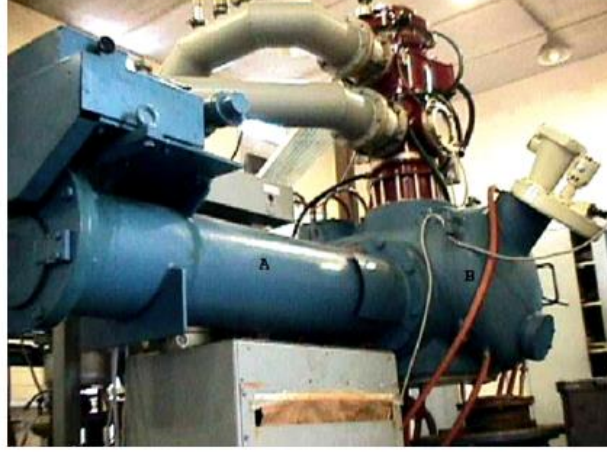
Şekil.2.21: EMO 80 Model 80kW gücünde EBM döküm ocağı. (a) yatay besleme yatağı (b) ergitme çemberi [82].
