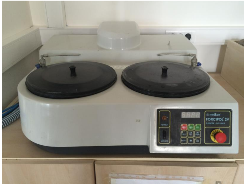
Őekil.3.4. Kullanılan zımparalama ve parlatma cihazı
