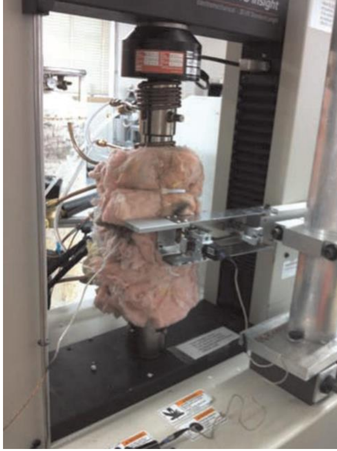
Şekil.3.9. Döngüsel çekme basma deneylerinin gerçekleştirildiği test düzeneği.
