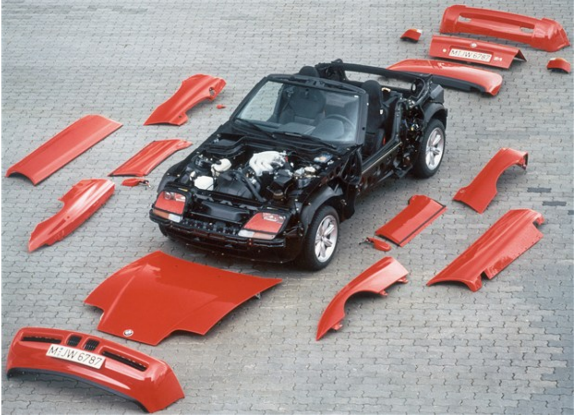
Şekil 1.23 Plastik gövde panelleri sökülmüş bir BMW Z1
