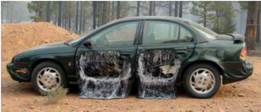
Şekil 1.22 Yangın sonucunda plastik panelleri deforme olmuş bir Saturn
