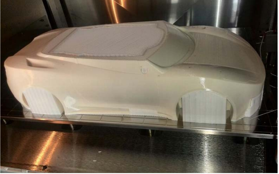
Şekil 3.18 1/5 ölçekli modelin üç boyutlu yazıcı ile üretimi
