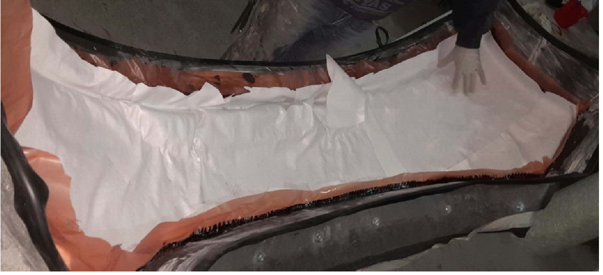
Şekil 5.13 Reçinenin emilmesi için konulan keçe tabaka
