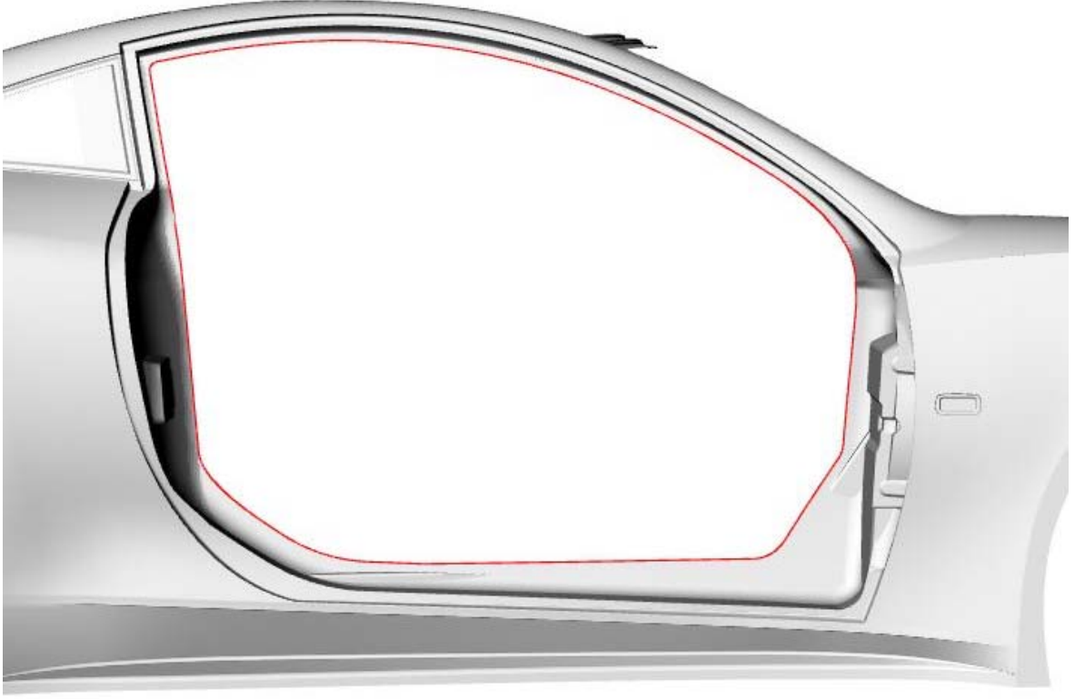
Şekil 4.23 Tamamlanan kapı yuvası
