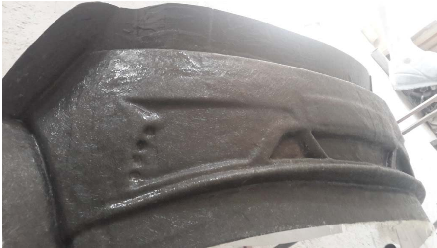
Şekil 5.8 Ön tampon kalıbının hazırlanması
