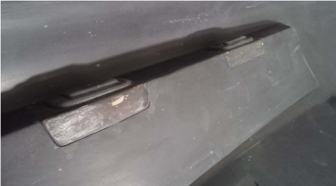
Şekil 5.10 Arka tampondaki plaka aydınlatmaları için konulan maçalar
