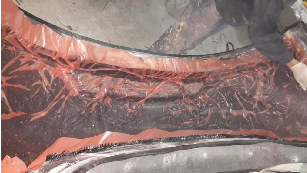
Şekil 5.12 Fazla reçinenin tahliyesinde kullanılan gözenekli naylon
