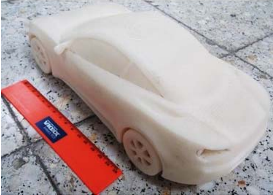
Şekil 3.15 Üç boyutlu yazıcı ile üretilen 1/14 ölçekli model
