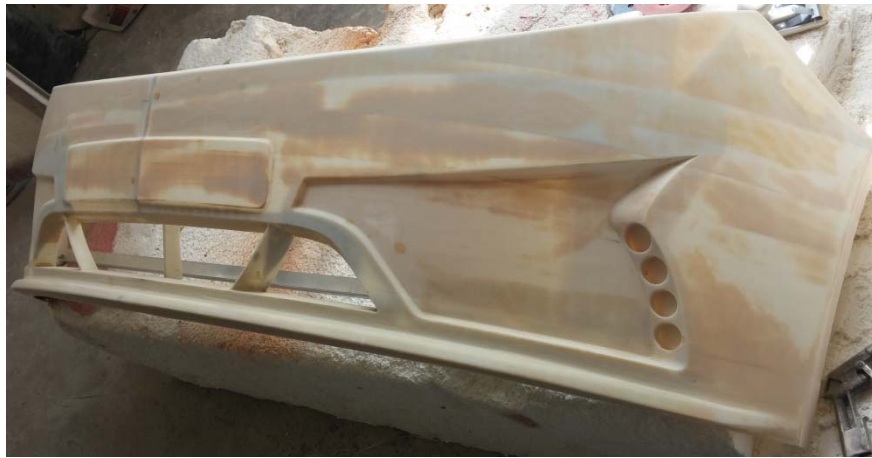
Şekil 5.6 Macun ve zımpara işleminden sonra ön tampon kalıp modeli
