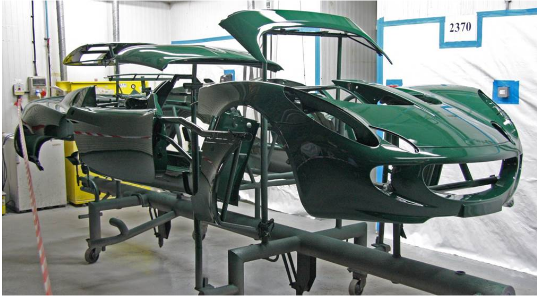
Şekil 1.26 Boyanmış Lotus Elise fiber kompozit body panelleri
