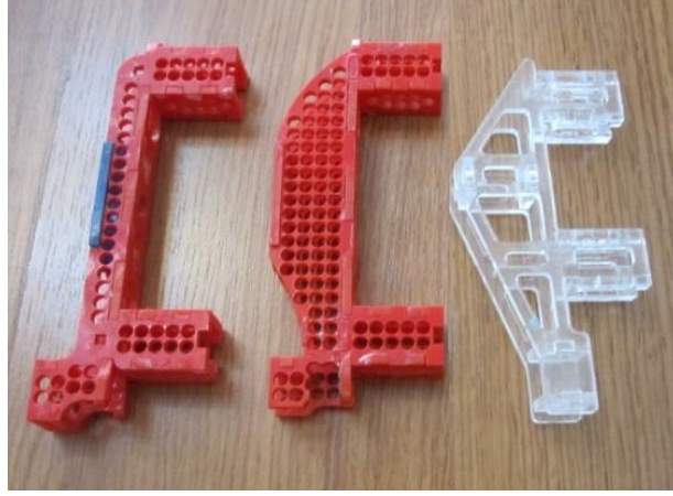
Şekil 3.30. Şase Tasarımları (Soldan Sağa, Şase Tasarımı-III, Şase Tasarımı-III Draft, Şase Tasarımı-II)
