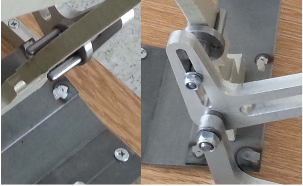
Şekil 8.2. Esnek mekanizmanın dört çubuk mekanizmasına bağlanması
