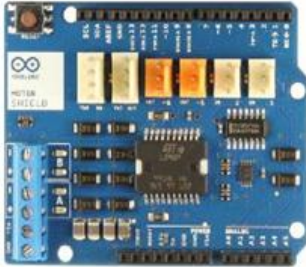
Şekil 2.20 Motor sürücü devresi arduino motor kartı
