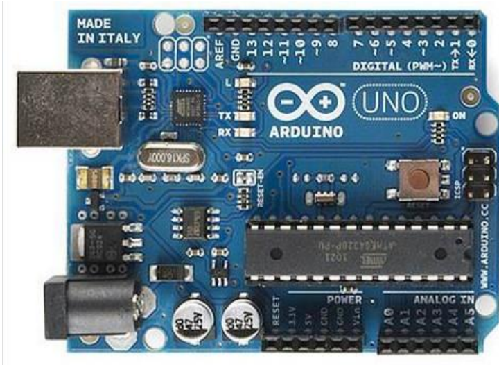
Şekil 2.19. Parça işleme istasyonlarında işlemci olarak kullanılan arduino uno
