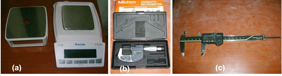
Şekil 4.6.Çalışmada kullanılan diğer ölçüm aletleri, (a) Elektronik tartı, (b) sayısal mikrometre, (c) sayısal kumpas
