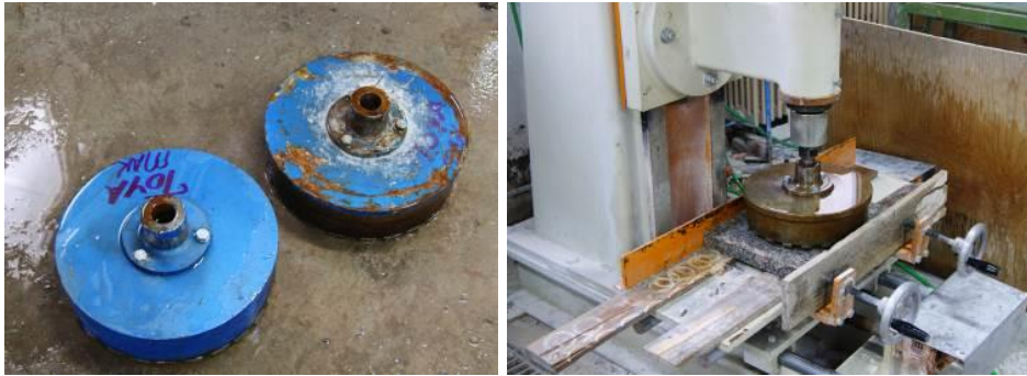
Şekil 4.3. Her bir kayaç grubu için özel olarak imal ettirilmiş dış çapı 300 mm iç çapı 60 mm olan karotiyerler
