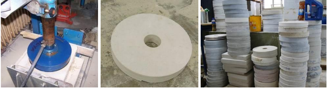
Şekil 4.4.Kare şekilli numunenin özel imalat karotiyer kullanılarak test cihazına takılabilecek uygun numune haline getirilmesi
