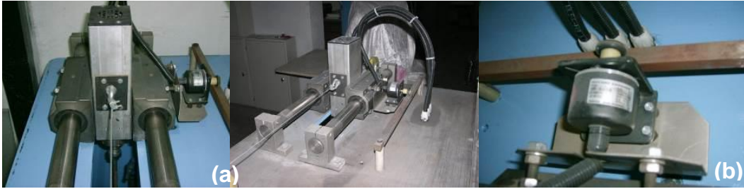
Şekil 3.5. Elmas boncuğu hareket ettiren havalı basınç sistemi ile yataklama sistemi (a) ve rotary encoder (b)
