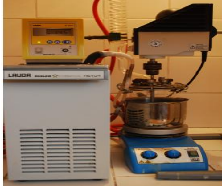
Şekil 4.1. Asidik hidrolizin gerçekleştirildiği deney sistemi
