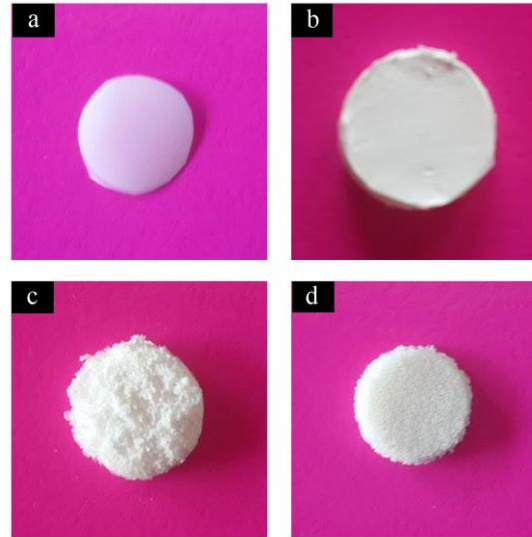
Şekil 4.4. Çeşitli fabrikasyon yöntemleri ile üretilen doku iskelelerinin görüntüleri: (a) çözücü buharlaştırma, (b) elektroegirme, (c) çözücü döküm-parçacık uzaklaştırma, (d) eriyik kalıplama- parçacık uzaklaştırma
