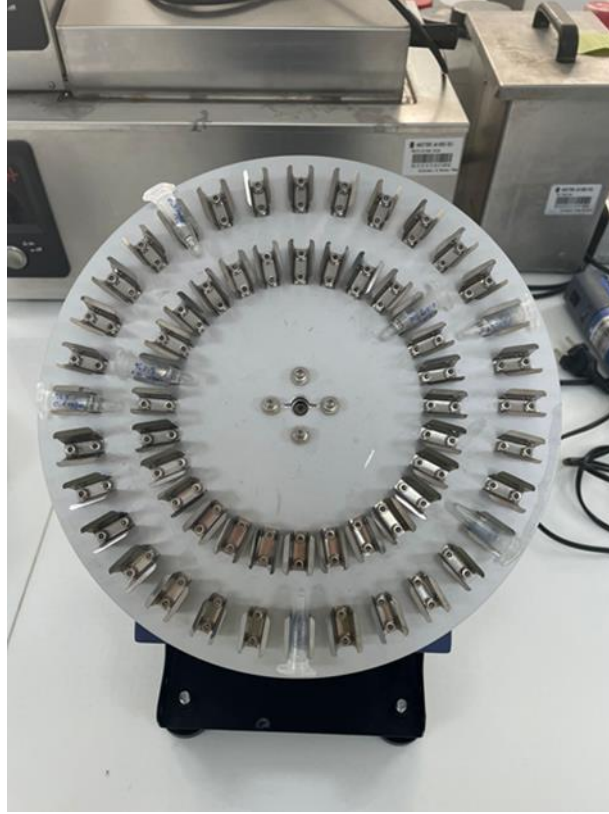
Şekil 12. Adsorpsiyon çalışmaları için kullanılan kesikli sistem düzeneği.
