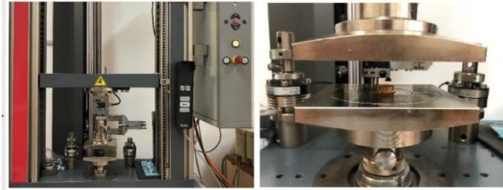
Şekil 3.11. ZC010 evrensel test cihazı basma test aparatı
