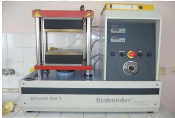
Şekil 3.4. Brabender Polystat-200T sıcaklık kontrollü pres
