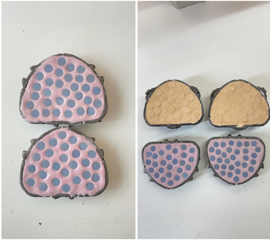
Şekil 3.2. Konvansiyonel ısıyla polimerize kaide materyali için muflaların hazırlanması
