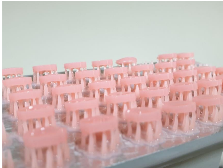
Şekil 3.5. 3 boyutlu yazma işlemi sonrası platforma bağlı örneklerin görüntüsü
