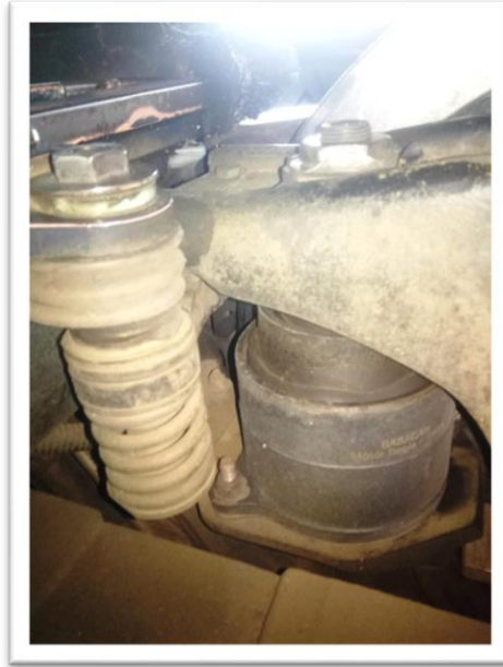
Şekil 4. 16. Konik Yayın Sirio Tramvayındaki Kullanım Yeri
