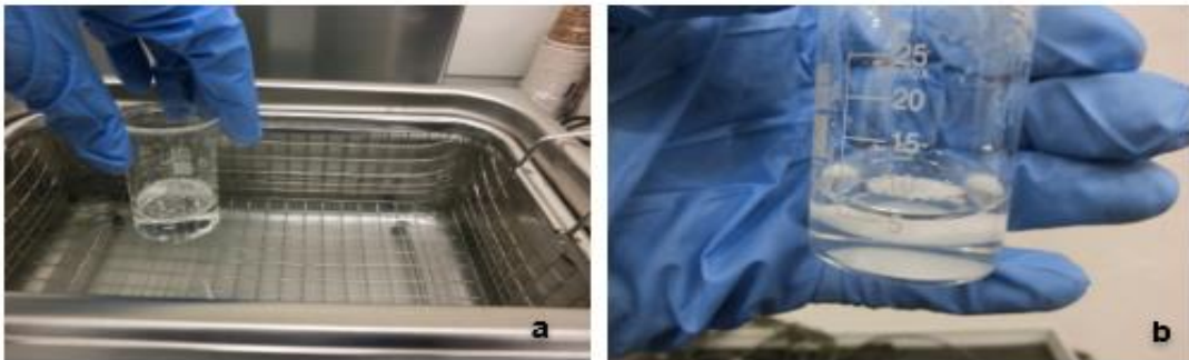
Şekil 3.1. a) Ultrasonik banyoda DMF içerisinde PVDF’ in çözdürülmesi b) Tamamen çözünen PVDF’nin görüntüsü.
