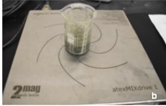
Şekil 3.2.a) Metal ve oksitleyici içeren kuru karışım içerisine PVDF eklenmesi b) Manyetik karıştırıcı üzerinde tüm bileşenlerin fiziksel olarak karıştırılması.
