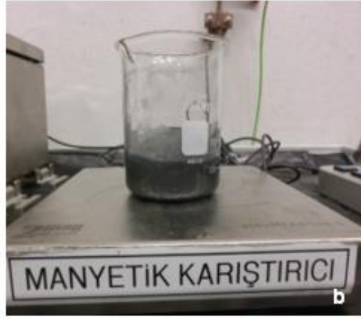
Şekil 3.6.a) Metal ve oksitleyici malzeme içerisine Hekzan eklenmesi b) Eklenen tüm malzemelerin manyetik karıştırıcı üzerinde karıştırılması.
