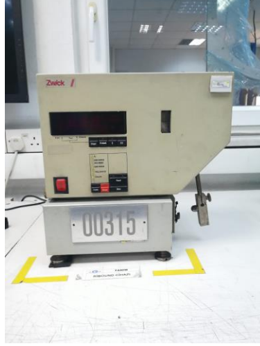
Şekil 3. 9. Geri sekme elastikiyetinin ölçüldüğü cihaz
