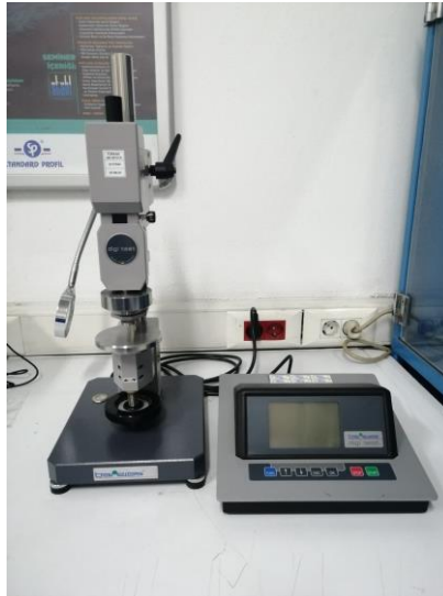
Şekil 3. 8. Digi test II-a Modularized Tester sertlik ölçüm cihazı
