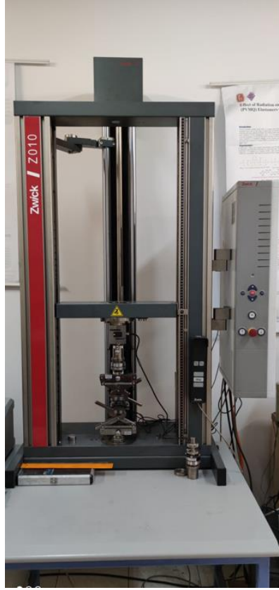
Şekil 3. 7. Zwick Z010 marka evrensel test cihazı
