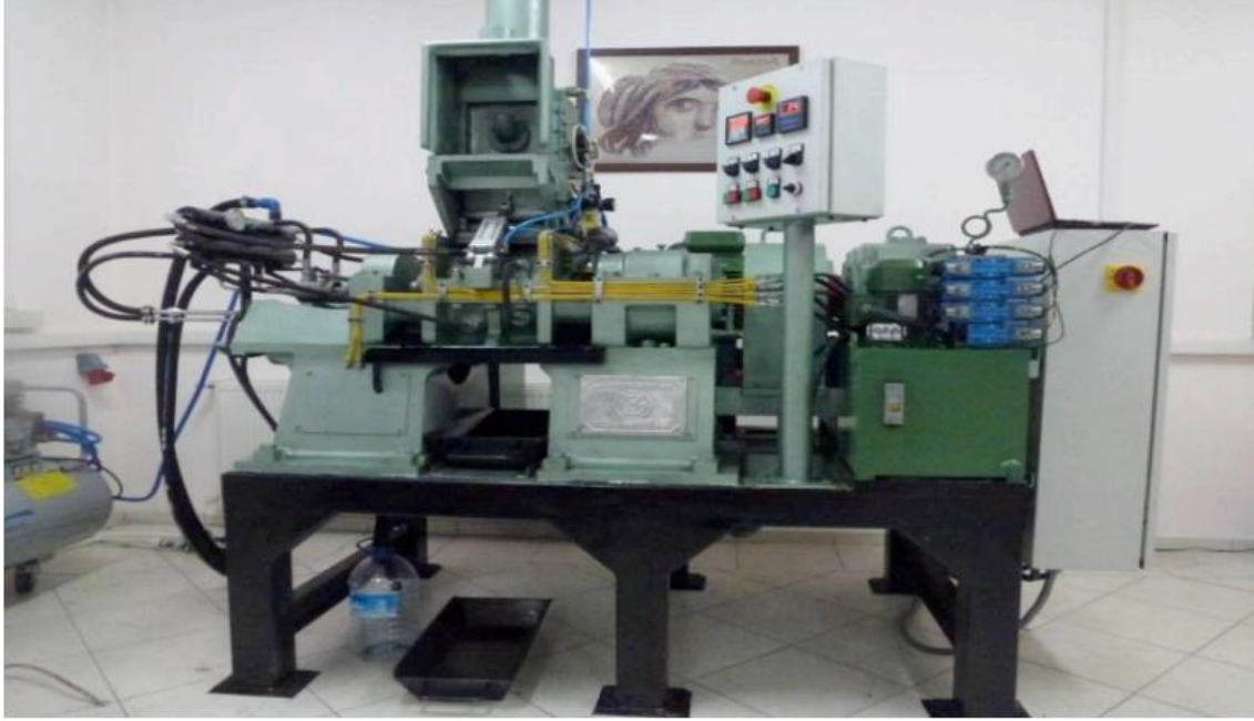
Şekil 3. 2. Kauçuk hamurlarının hazırlanmasında kullanılan Met-Gür marka dahili karıştırıcı
