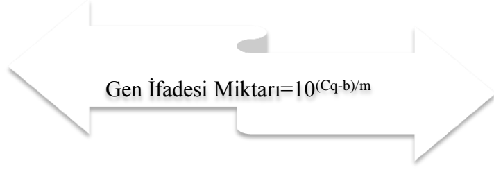
Şekil.3.9. Absolut kuantifikasyon gen ifade miktarı (Cq: Kantifikasyon döngüsü, b: Standart eğride y eksenini kesen nokta, m: Standart eğri eğimi)
