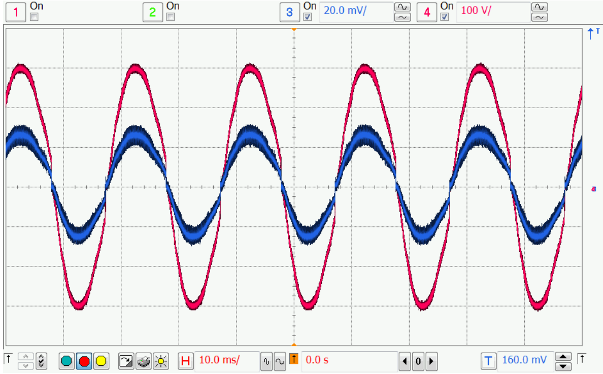
Şekil 5-5 %20 Yük Altında Çıkış Akımı (Kanal3) ve Çıkış Gerilimi (Kanal4) (Kanal3: 0.2A/böl, Kanal4: 100V/böl)
