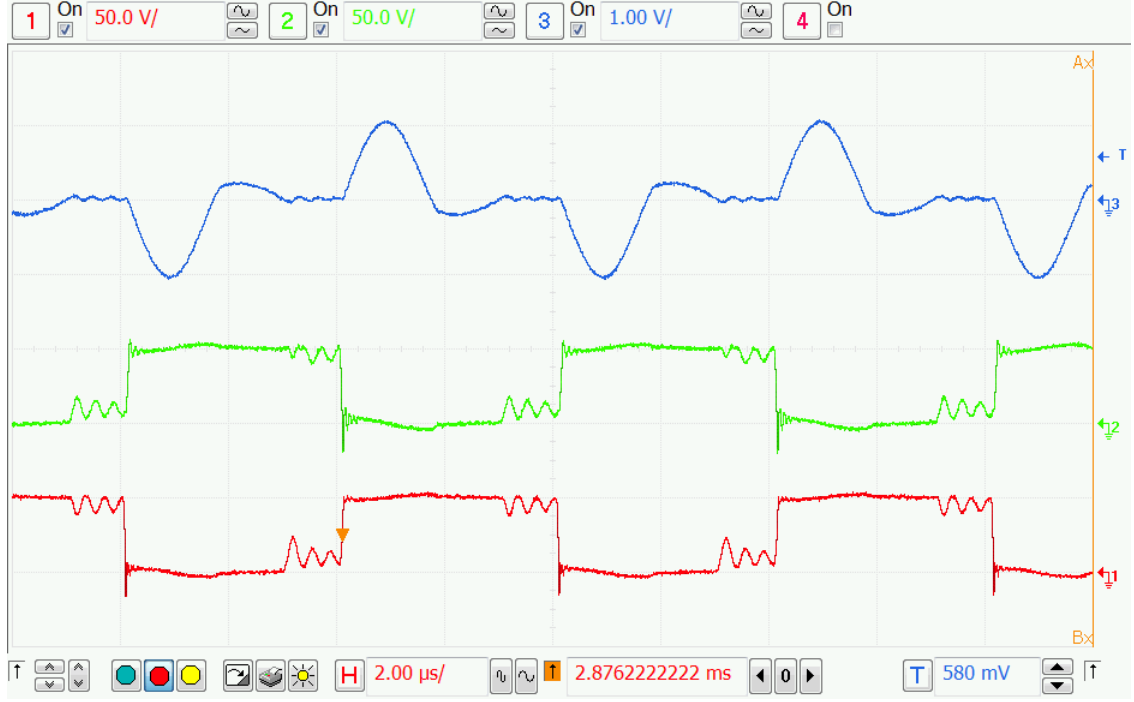
Şekil 5-11 Kapalı Çevrim, Tam Yük, Rezonans Akımı (Kanal3) ve Tam Köprü Bacak Gerilimleri (Kanal1-Kanal2)
