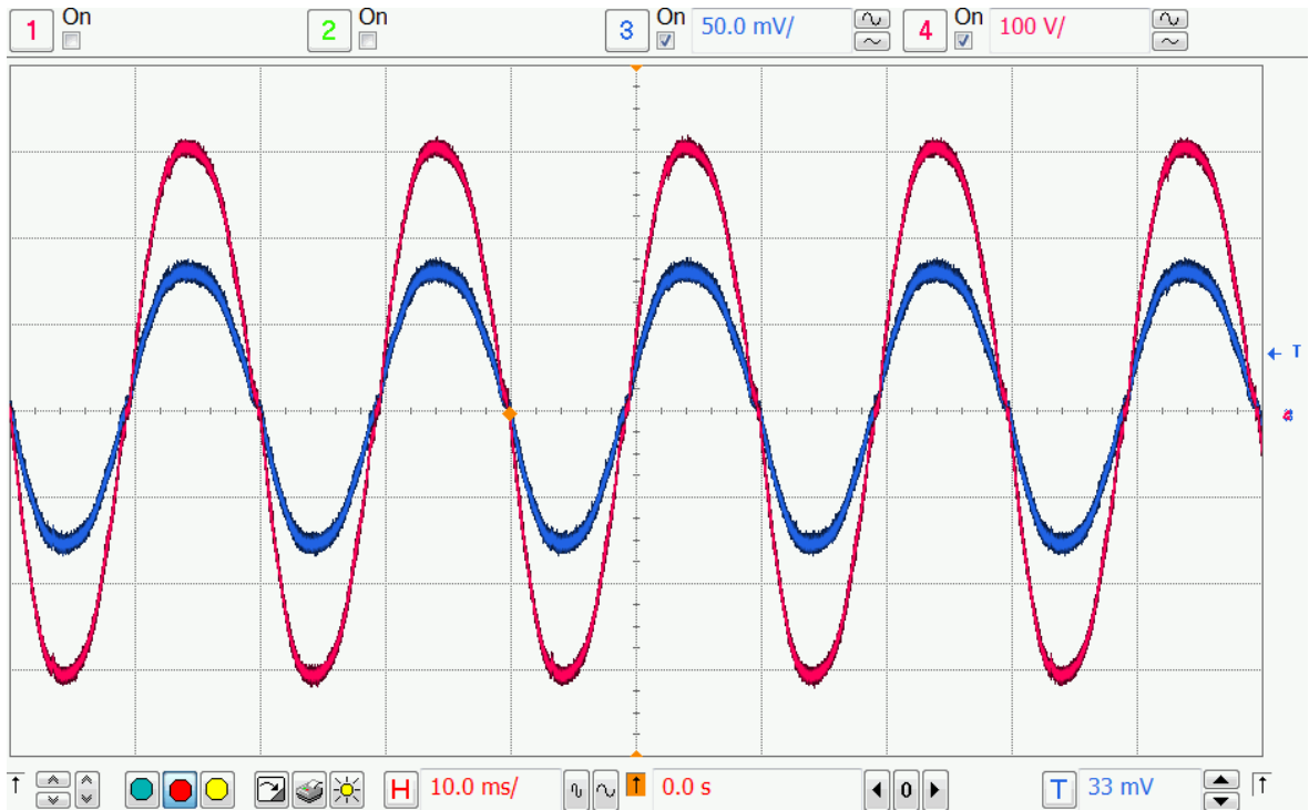
Şekil 5-6 60% Yük Altında Çıkış Akımı (Kanal3) ve Çıkış Gerilimi (Kanal4) (Kanal3: 0.5A/böl, Kanal4: 100V/böl)
