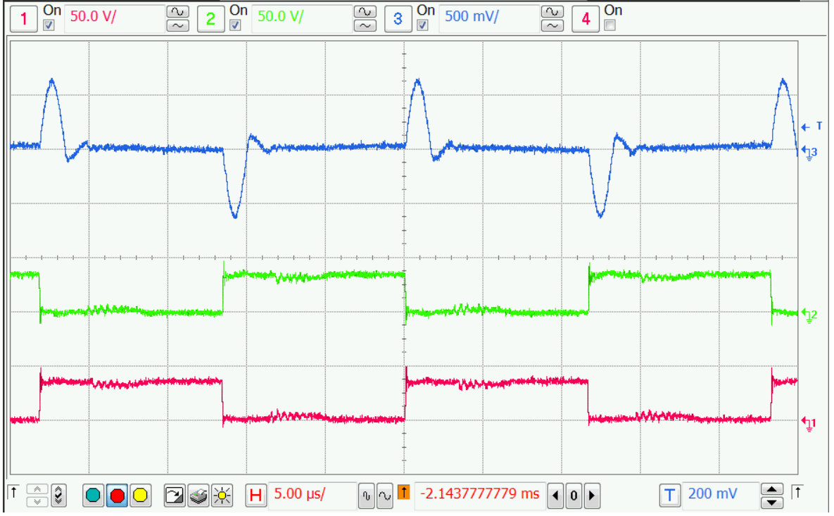
Şekil 5-2 20% Yük, Rezonans Akımı (Kanal3) ve Tam Köprü Bacak Gerilimleri (Kanal1-Kanal2)
