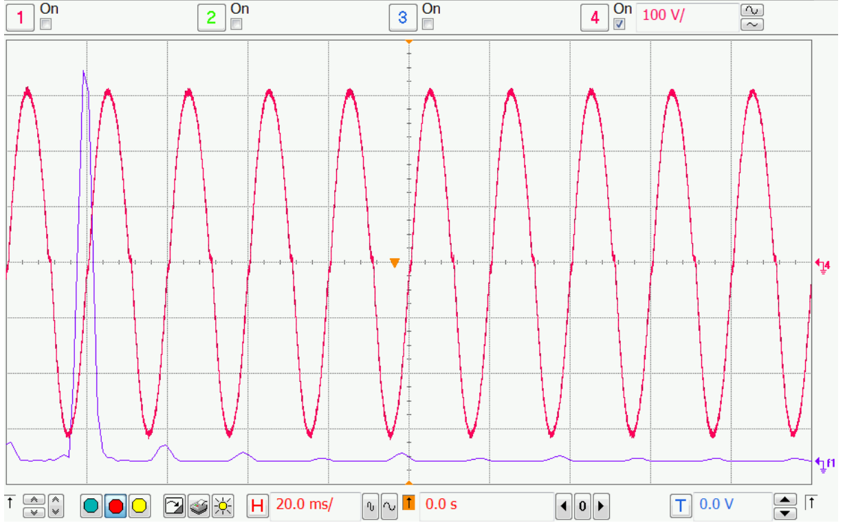
Şekil 5-8 Tam Yük Altında Çıkış Gerilimi (Kanal4) ve Harmonikleri (f1)
