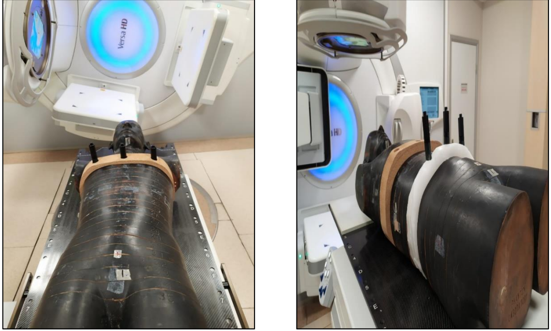
Şekil 3.7. Akciğer ve prostat ölçümleri için hava eşdeğeri mantar ve doku eşdeğeri balmumu bloklar kullanılarak kabarcık dedektörlerinin yerleştirilebilmesi için uygun kesitlerin hazırlanması ve konumlandırılması
