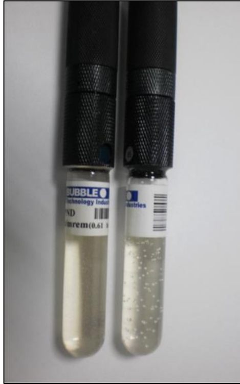
řekil 3.3. Işınlanmış (soldaki) ve ışınlama sonrası sönümlendirilmiş (sađdaki) kabarcık dedektörleri
