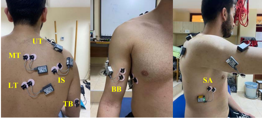
Şekil 3.2. SENIAM Kriterlerine göre elektrot yerleşimleri.
