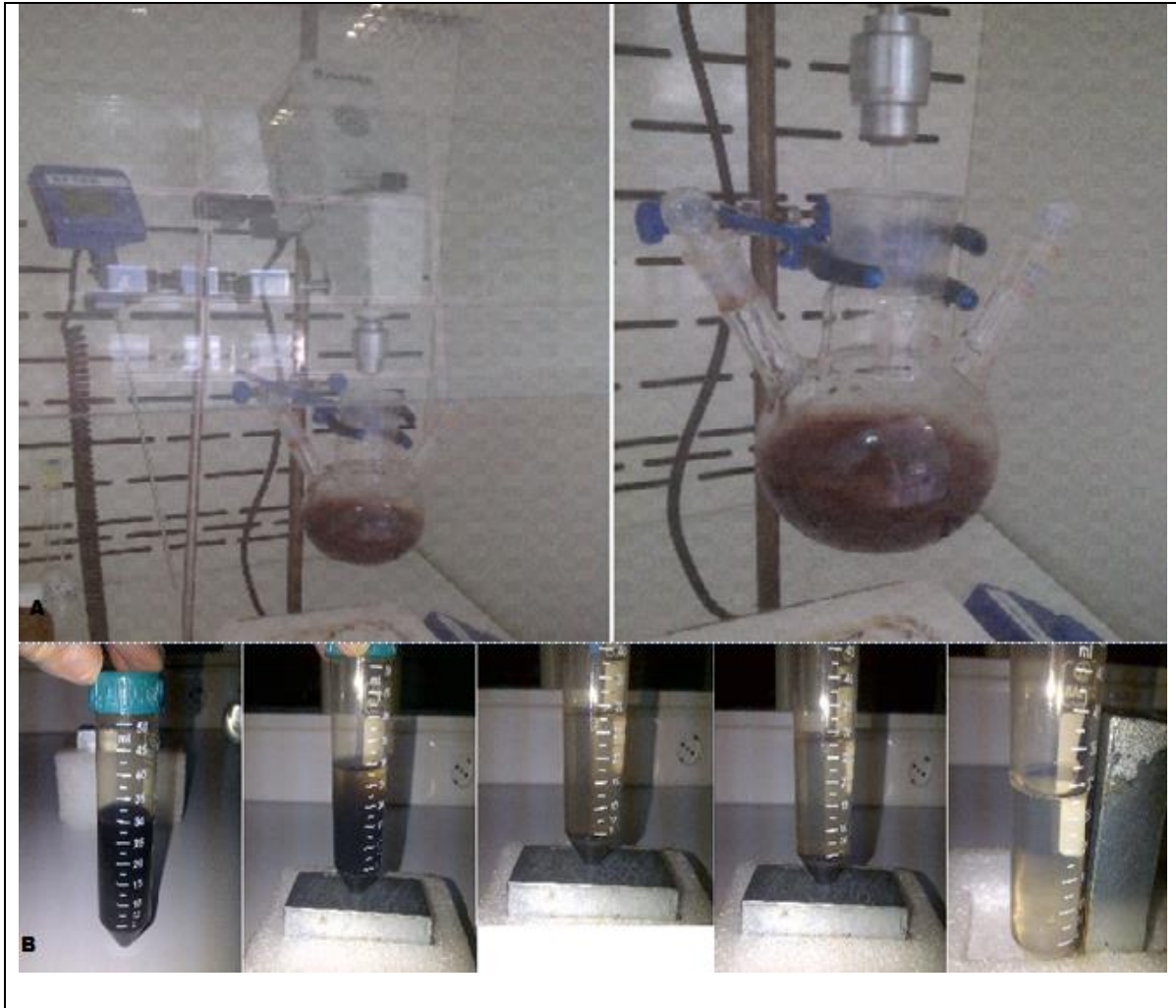
Şekil 3.1. (A) SPION'ların altın kaplama esnasında reaktör içerisindeki görünüşleri (B) Altın kaplı SPION'ların mıknatıs ile görüntüleri
