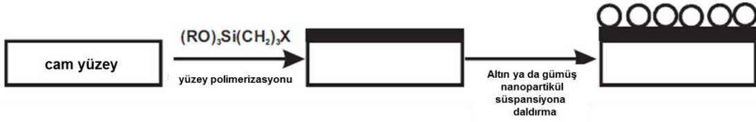
Şekil 2.11. Altın ya da gümüş tek tabaka nanopartikül kurulumu. X =CN, NH 2 , 2-piridil, P(C 6 H 5 ) 2 , ya da SH; R = CH 3 ya da CH 2 CH 3 [165]
