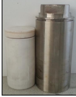
Şekil 3.2. Solvotermal yöntemle mantetit sentezinde kullanılan TEFLON-paslanmaz çelik reaktör sistemi
