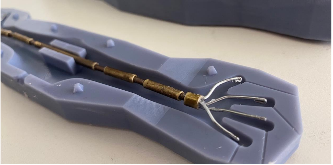
Görsel 79. Silikon göküm öncesi armatürün kalıp içinde pozisyonlandırılması
