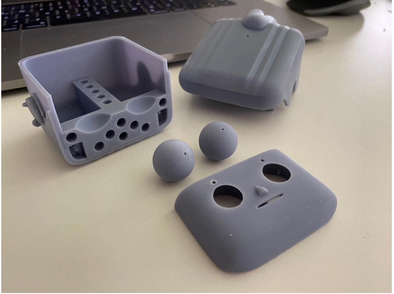
Görsel 73. Başı oluşturulan parçalar zımparalanmadan önce
