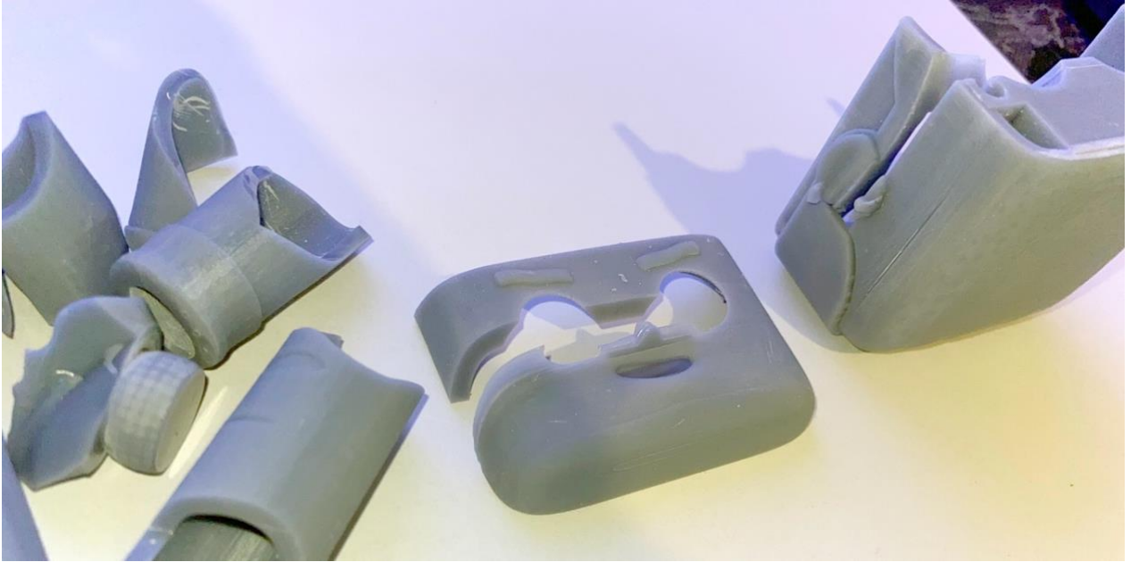
Görsel 75. Baskıda hatalı çıkan ya da temizleme sırasında kırılan parçalardan örnekler
