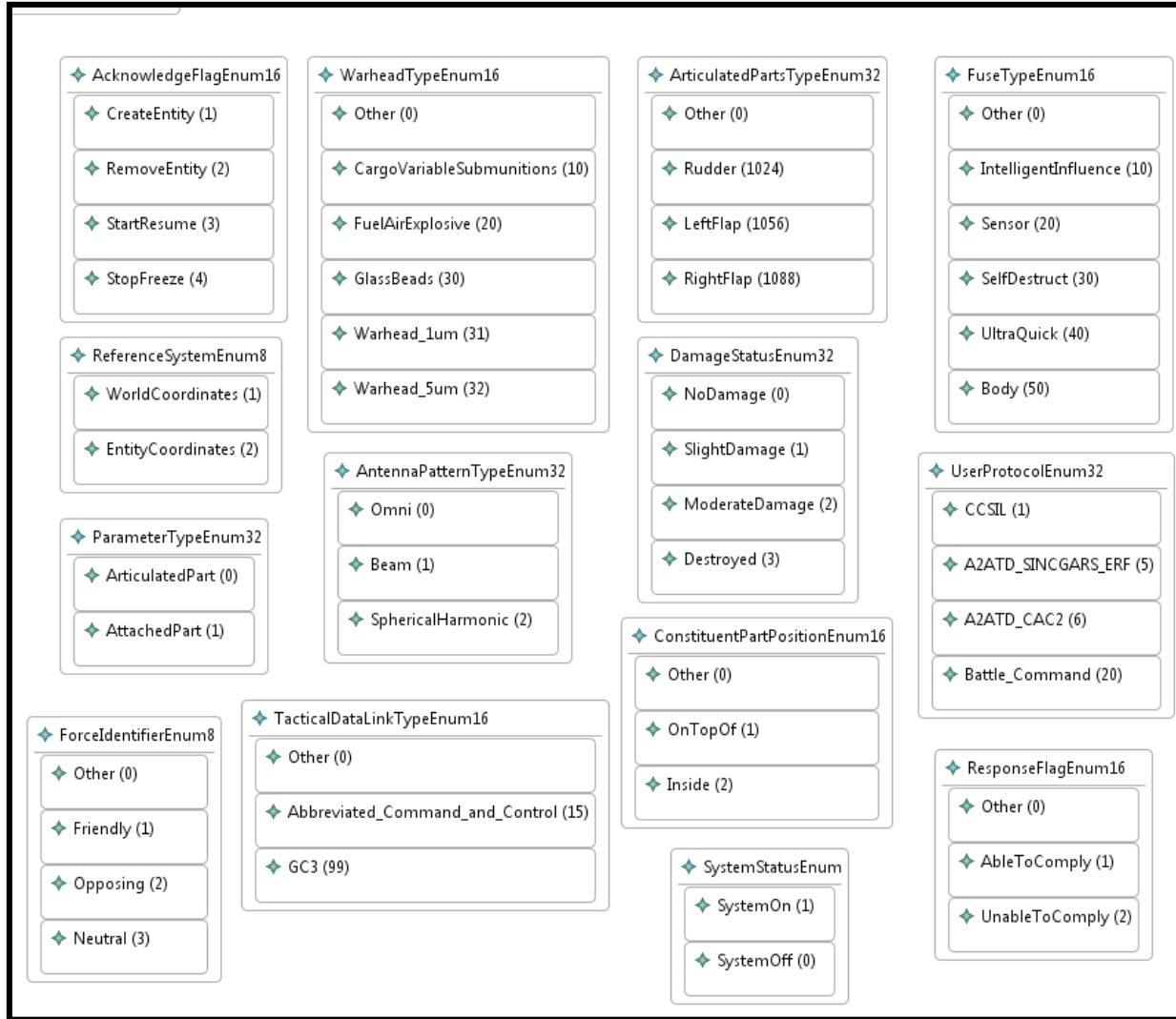
Şekil 7-6 RPR-FOM Numaralandırılmış Veri Türlerinin ( Enumerator ) S-IDE Geliştirme Ortamında Modellenmesi – Kesim #2
