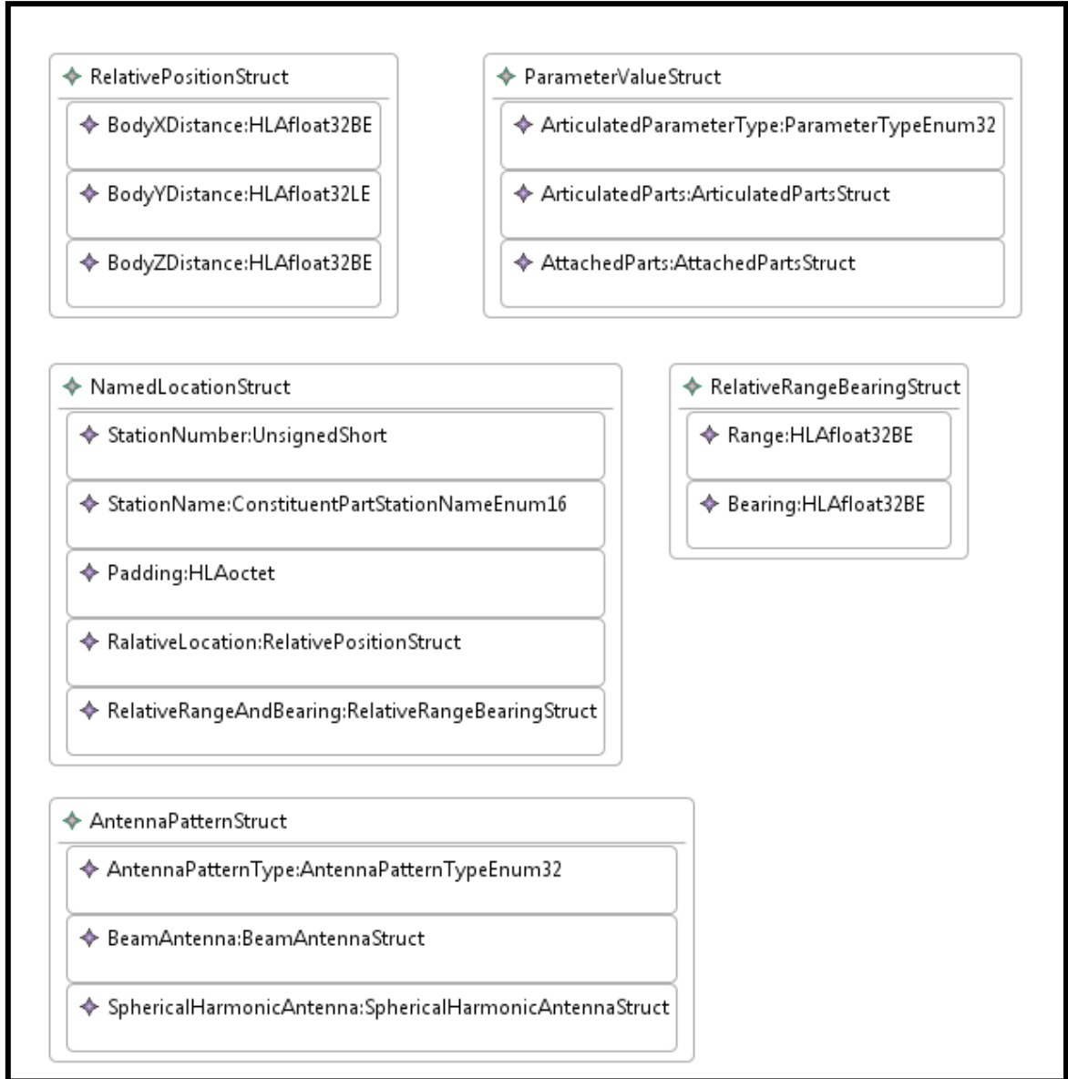
Şekil 7-2 RPR-FOM Sabitlenmiş Kayıt ( Fixed Record ) Veri Türlerinin S-IDE Geliştirme Ortamında Modellenmesi – Kesim #1
