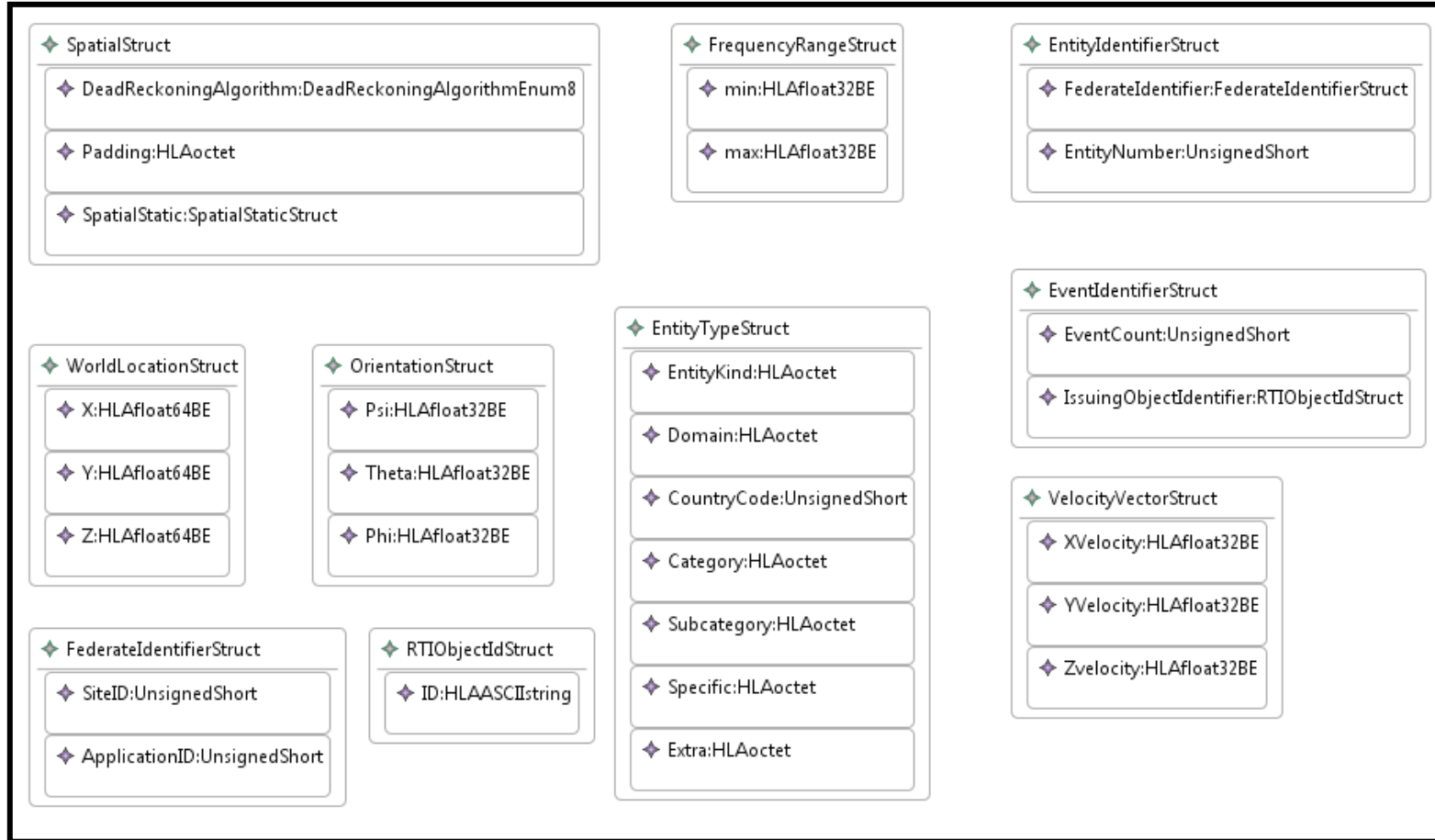
Şekil 7-3 RPR-FOM Sabitlenmiş Kayıt ( Fixed Record ) Veri Türlerinin S-IDE Geliştirme Ortamında Modellenmesi – Kesim #2
