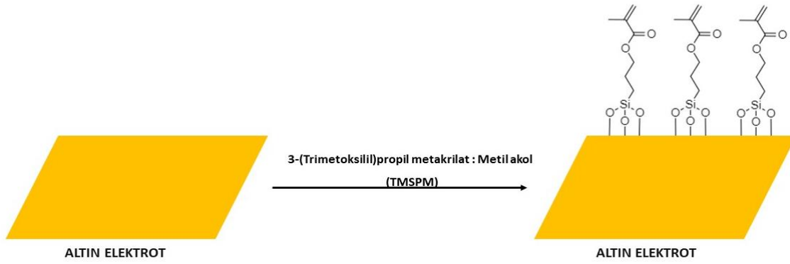
Şekil 3.3. Altın sensör yüzeyine vinil gruplarının bağlanmasının şematik gösterimi.
