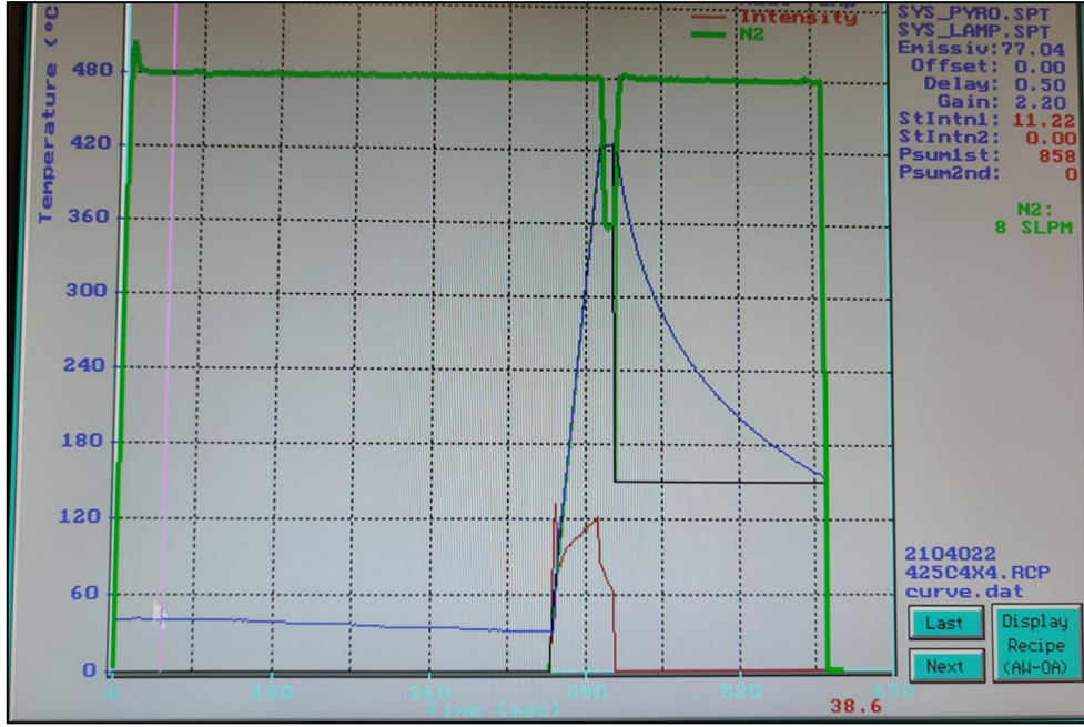
Şekil 4-24 Alttaşların tavlama işlemindeki zamana bağlı sıcaklık eğrisi.
