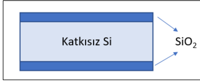
Şekil 4-4 Oksidasyon işlemi sonrası aygıtların kesit görüntüsü.
