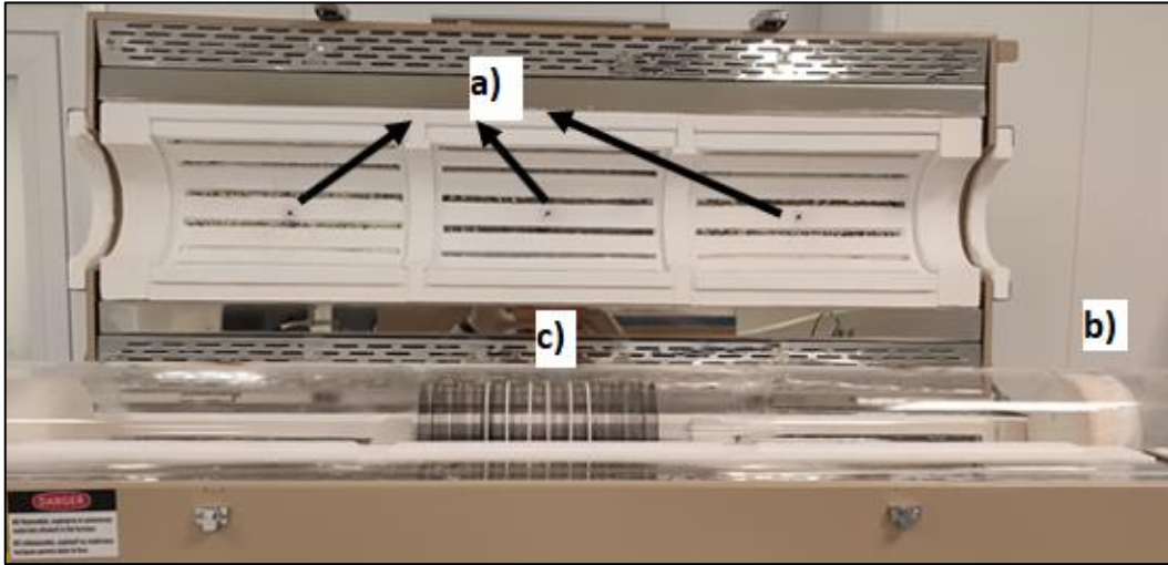
Şekil 4-16 a) 3 bölge ön yüz bor katkılama fırınının termoelektrik çiftleri b) termal blok c) alttaşların bulunduğu kuvarz kayık
