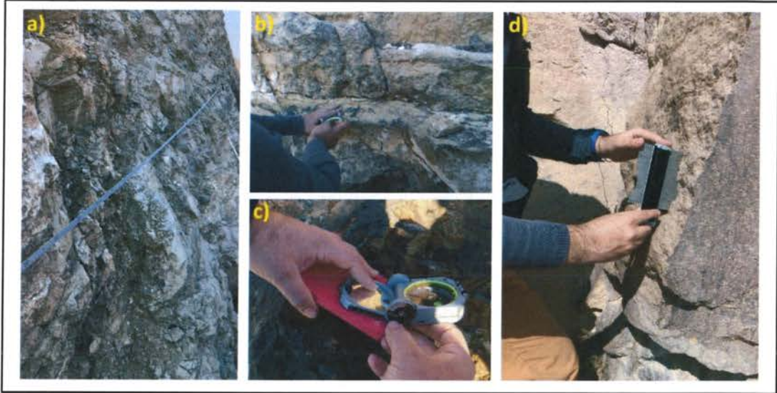
Şekil 4.7. Hat etüdü (a), brunton pusulası ile tabaka ölçümü (b), yapay süreksizlik yüzeyinden yönelim ölçümü (c), profilometre ile pürüzlülük ölçümü (d).
