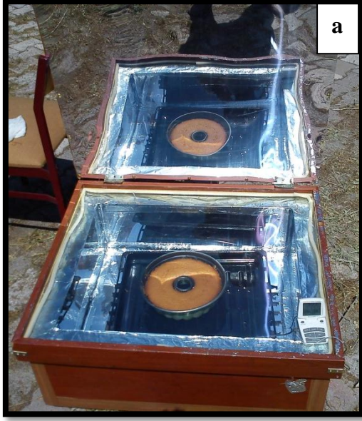
Şekil 3.12 : a) GEF-1'in iç yüzeyinin ve yansıtıcısının yenilenmiş görüntüsü b) GEF-1'in ilk görüntüsü
