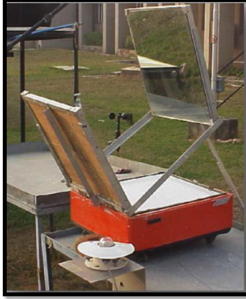
Şekil 2.7 : Negi ve Prohit tarafından tasarlanan kutu tipinde GEF
