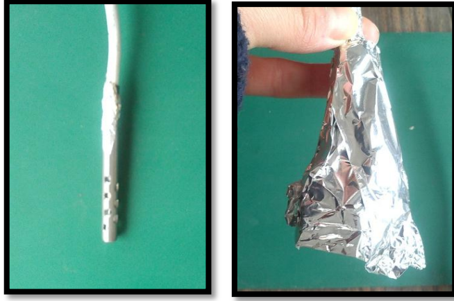
Şekil Ek 4.3 : Sıcaklık sensörü 3(GEF iç hava sıcaklığı)
