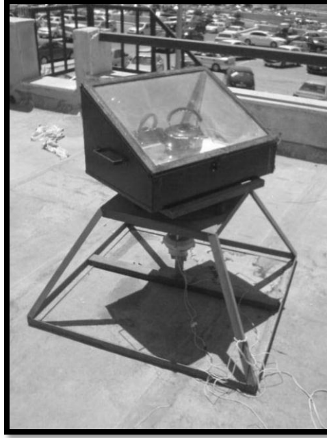
Şekil 2.14 : El-Tous ve arkadaşlarının tasarladığı izleme sistemine sahip pişirici
