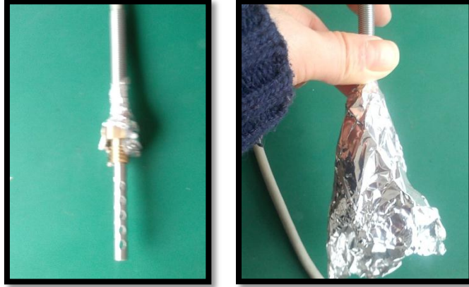
Şekil Ek 4.4 : Sıcaklık sensörü 4(Dış hava sıcaklığı)
