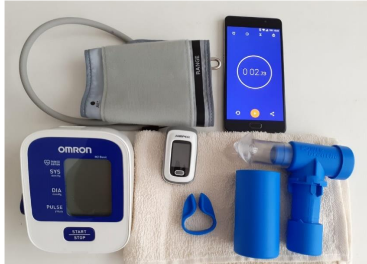
Şekil 3.4. Testler sırasında kullanılan cihazlar (Soldan Sağa: Tansiyon Aleti, Pulse Oksimetre, Kronometre ve POWERBreathe)
