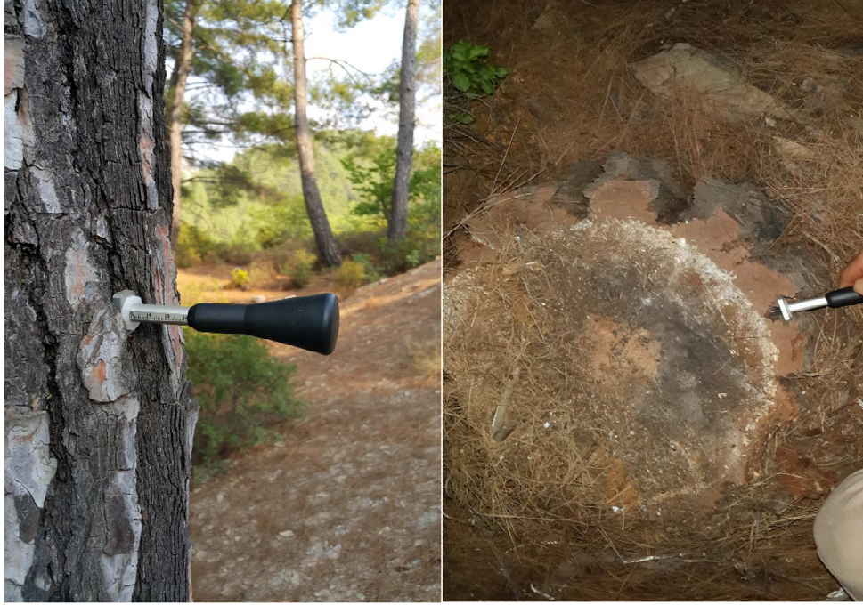
Şekil 4.3. Kabuk kalınlığı ölçer ve Kızılcam kabuk kalınlığının ölçülmesi (Fotoğraf: Çağatay Tavşanođlu, D. Deniz Kazancı)
