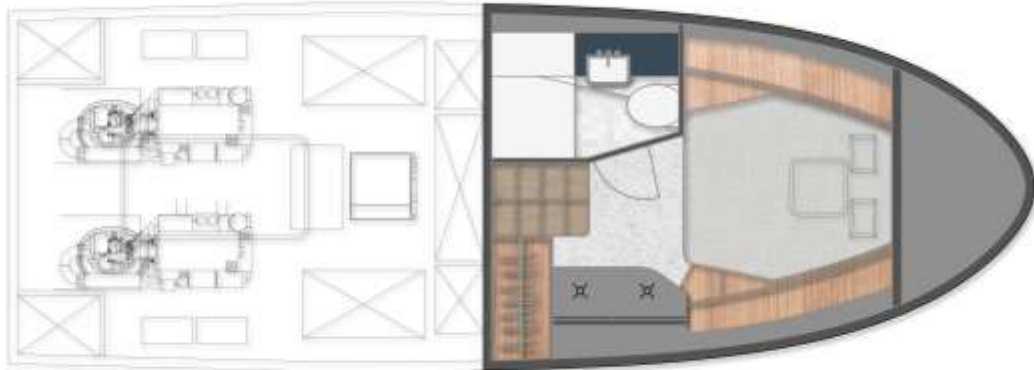
Şekil 4.4. 11 metre "Marlin" motoryatının alt güverte planı
