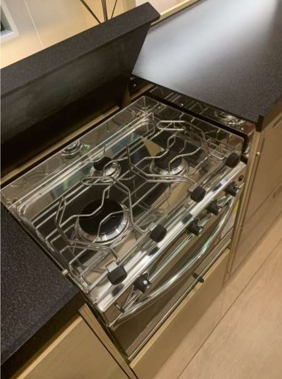
Şekil 2.39. 17,2 metre Hanse 588 yelkenli yatında bulunan salınım etkisini azaltıcı mekanizmaya sahip ocak-fırın seti
