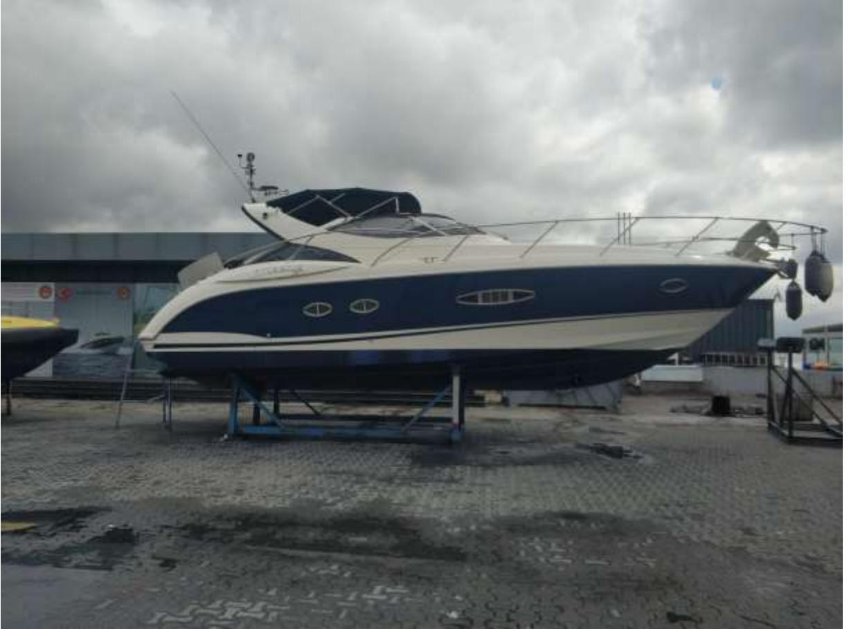
Şekil 2.26. Bakım için karaya çekilen fiberglas motoryat
