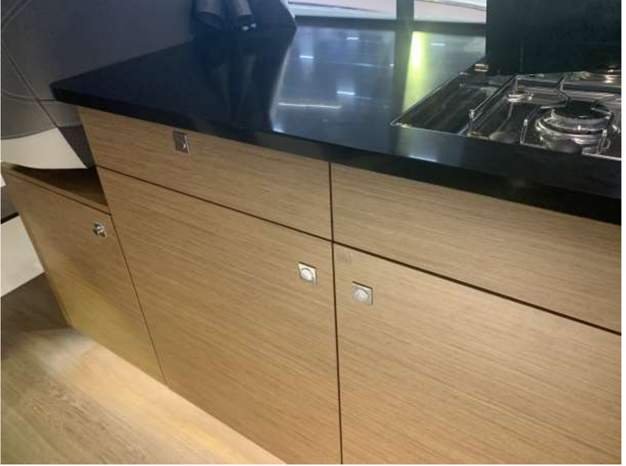
Şekil 2.40. 10,5 metre Jeanneau Merry Fisher 1095 Fly motoryatının kapak ve çekmecelerinde bulunan bas-aç kilit sistemi
