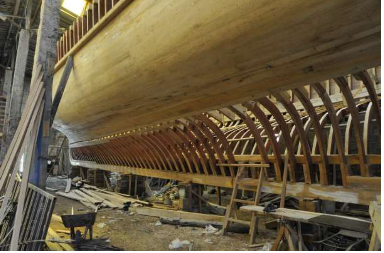
Şekil 2.24. Ahşap yat gövde kaplamasının yapım aşaması (Istock, 2021a)
