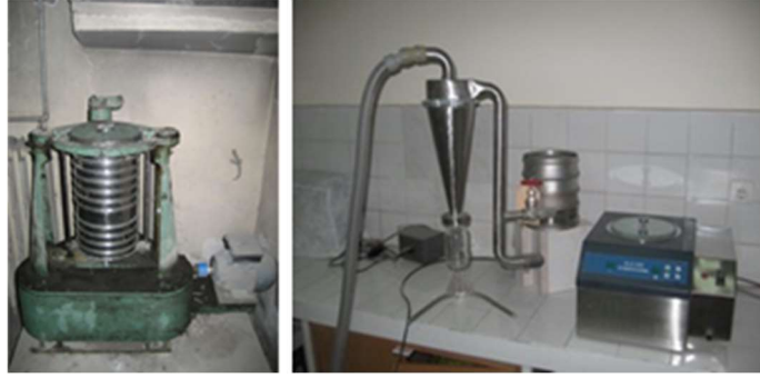
Şekil 3.2. Rotap elek cihazı ve havalı alpine cihazı
