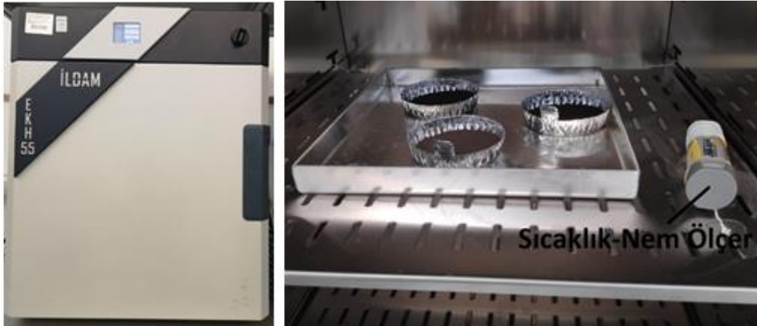
Şekil 3.5. Hızlandırılmış Yaşlandırma Test Düzenegi (Sol Görsel-Fırın Dış Görüntüsü, Sağ Görsel-Fırın İç Görüntüsü)
