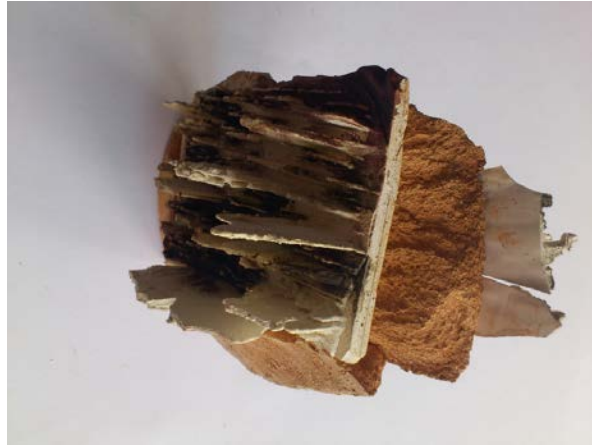
Şekil 23: Dokuların Mangan Oksit İle Oksitlenerek Şamotlu Kil Birleşimi
