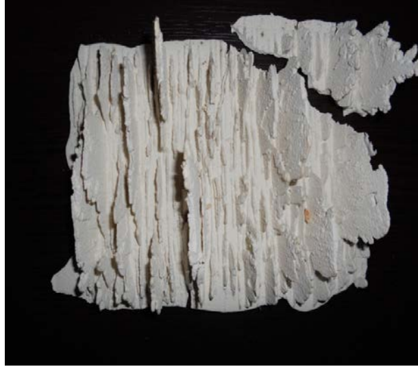
Şekil 18: Bisküvi Pişirimi Sonrası Çamurun Aldığı Şekil
