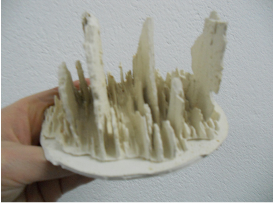
Şekil 20: 1000 °C lik Bisküvi Pişirimi Sonucu
