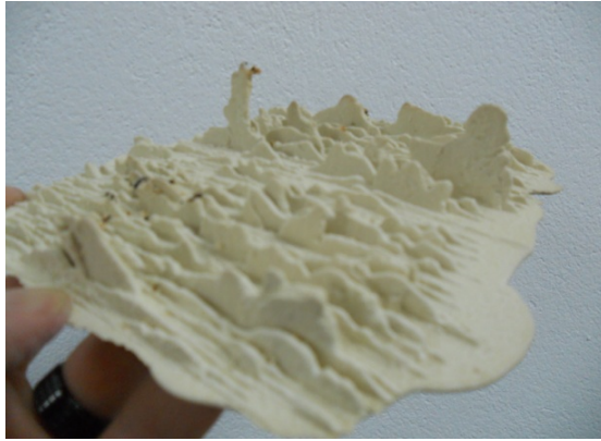
Şekil 19: 1000 °C lik Bisküvi Pişirimi Sonucu
