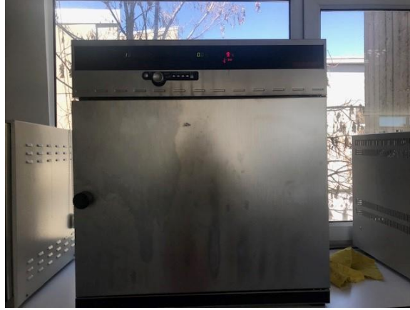
Şekil 3.11. Memmert marka etüv.
