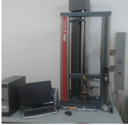
Şekil 3.8. Zwick marka Evrensel Test Cihazı
