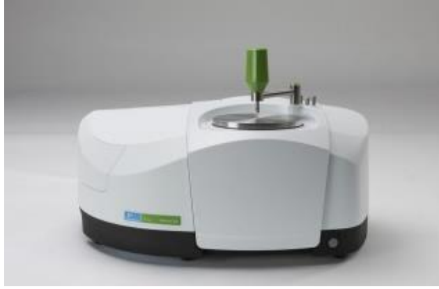
Şekil 3.1. Perkin-Elmer, Spectrum II model FTIR cihazı
