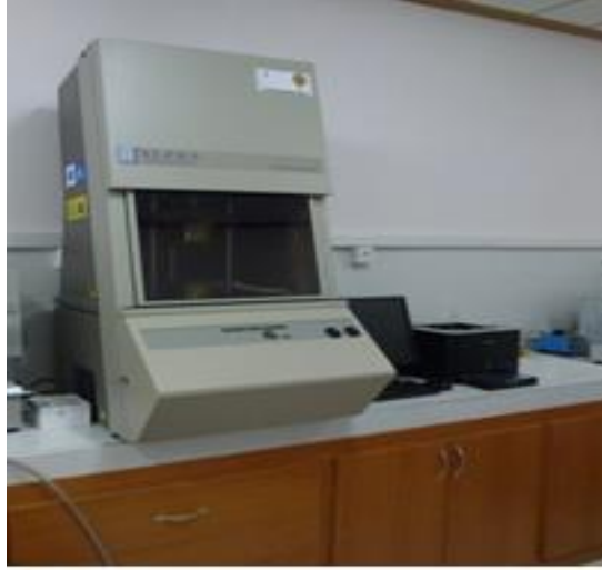
Şekil 3.4. Alpha marka Hareketli Kalıp Reometresi.
