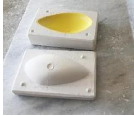
Görsel 179: 'Olive' lavabo maketi kalıp çalışması
