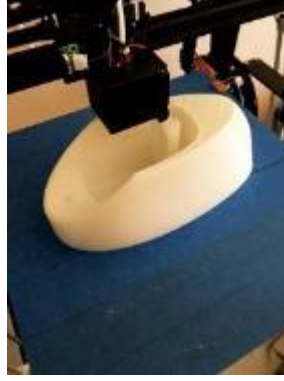
Görsel 172: 3D yazıcı kullanılarak basılan 'Code' pisuvarın 1/3 ölçekli modeli
