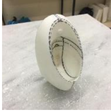
Görsel 176: 'Code' pisuar maketi kalıp parçalarının ayıran çizgilerin belirlenmesi
