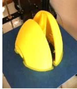
Görsel 174: 3D yazıcı kullanılarak basılan 'Olive' lavabonun 1/2 ölçekli modeli
