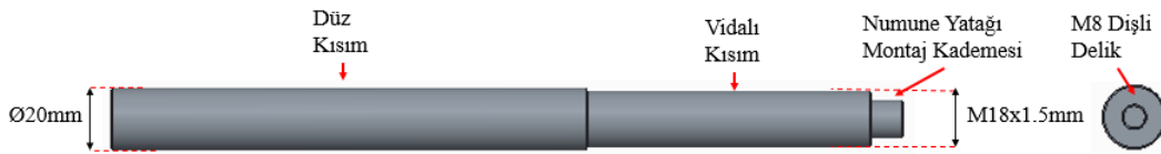
Şekil 4.18. Vidalı mil, yan ve arka görünüş
