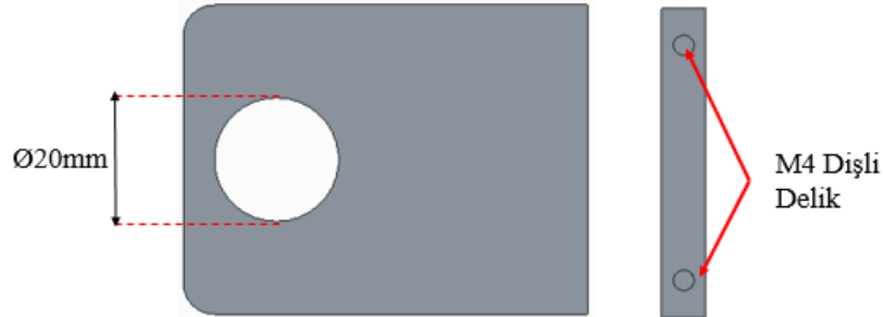
Şekil 4.16. Numune destek, ön ve alt görünüş
