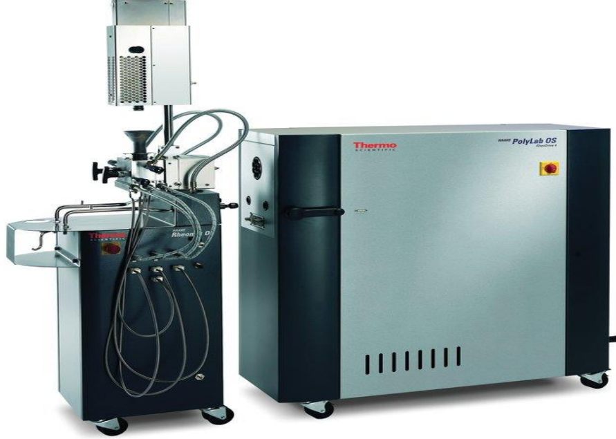
Şekil 3.1. HAAKE Rheomix OS Lab Mikser.
