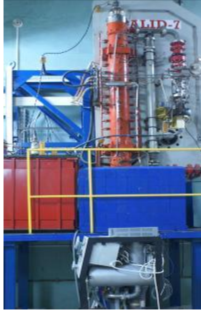
Şekil 3.6. Doğrusal elektron hızlandırıcı (ALID-7).
