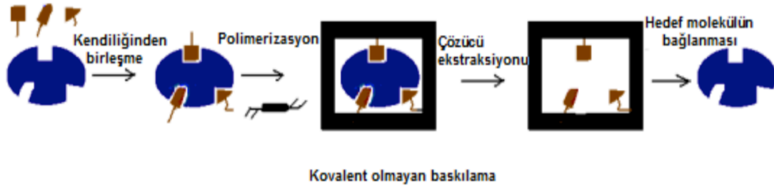
Şekil 2.16. Kovalent olmayan baskılama yönteminin gösterimi
