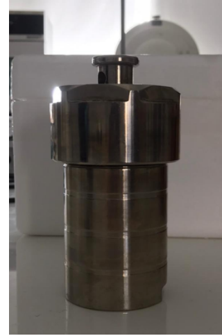
Şekil 2.9. Hidrotermal sentez yönteminde reaksiyonun gerçekleştirildiği otoklav ve şematik gösterimi [33]
