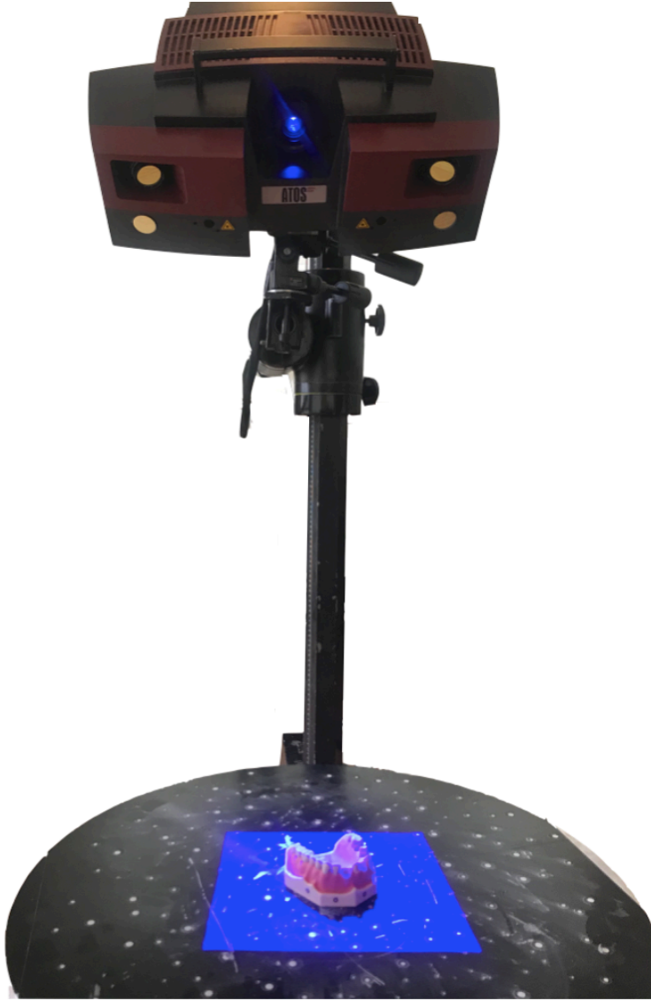
Şekil 3.13. ATOS Triple Scan endüstriyel tarayıcısı ile ana modelin taranması.
