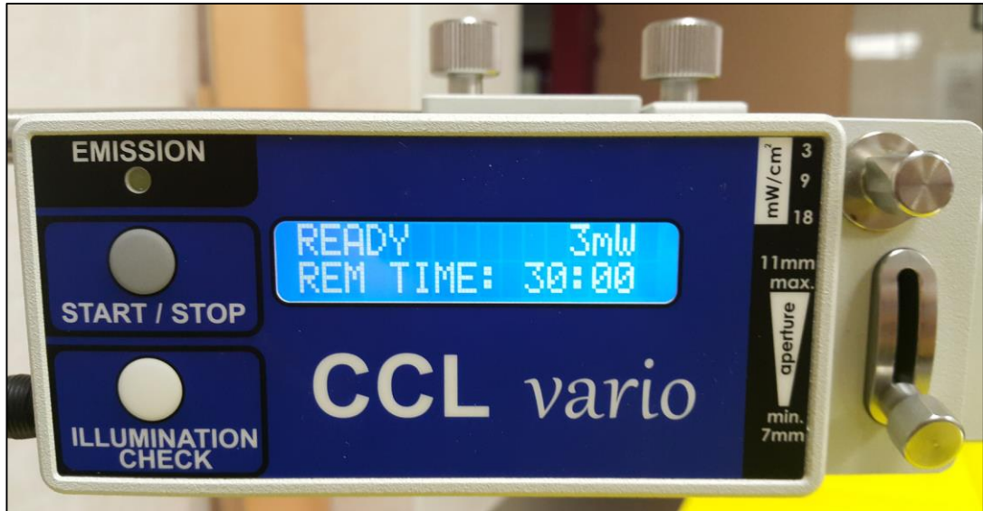
Şekil 3.7. Tavşan gözlerine UV ışığı uygulanması (korneal çapraz bağlama işlemi) için kullanılan CCL Vario cihazının parametrelerini gösteren fotoğraf.
