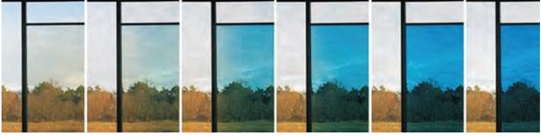
Görsel 40. Farklı yansıtıcı ve şeffaf durumlarına sahip olan akıllı pencere. Gesimat teknolojisi: elektrokromik cam sistemi (Ritter, 2007).
