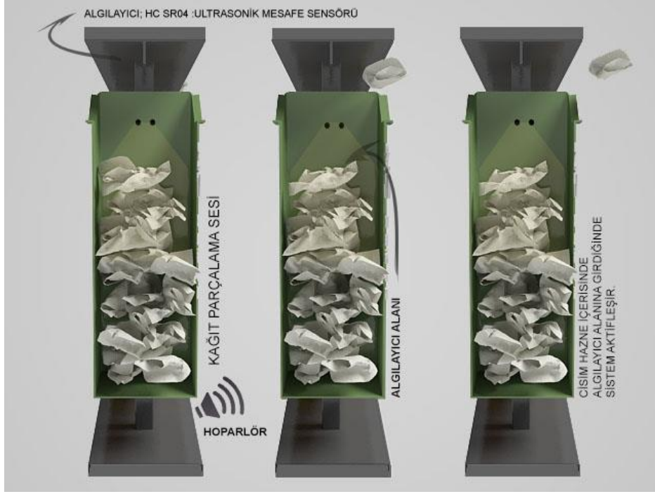
Görsel 73. Akıllı atık geri dönüşüm ünitesinde bulunan kağıt modülüne kağıt bir atığın atılması, Kağıt modülü kesiti. (kişisel arşiv)
