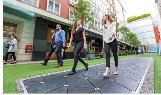
Görsel 63. THE PAVEGEN V3, hareket enerjisini elektrik enerjisine dönüştüren karolar (du Besse, 2018)
