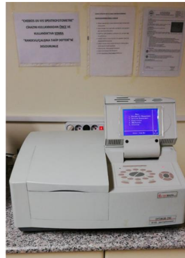
Şekil 3.5. Müsinle etkileşim çalışmaları kapsamında gerçekleştirilen turbidimetrik tayin analizlerinin spektrofotometre cihazı ile gerçekleştirilmesi süreci.
