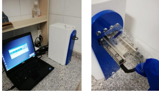
Şekil 3.20. Hücre sayım işleminin gerçekleştirildiği cihaz (Cedex XS Cell Analyzer) ve 1:4 oranında seyreltilerek tripan mavisi ile boyanan hücrelerin sayım apareyine uygulanması işlemi.
