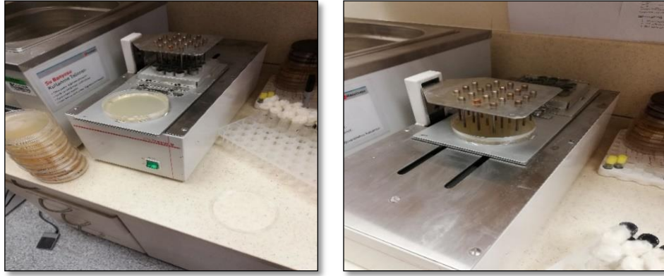
Şekil 3.4. Agar dilüsyon cihazı ve suşların plaklara ekimi.
