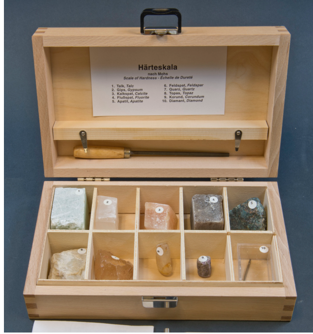
Şekil 2.11. Mohs Sertlik test kiti
