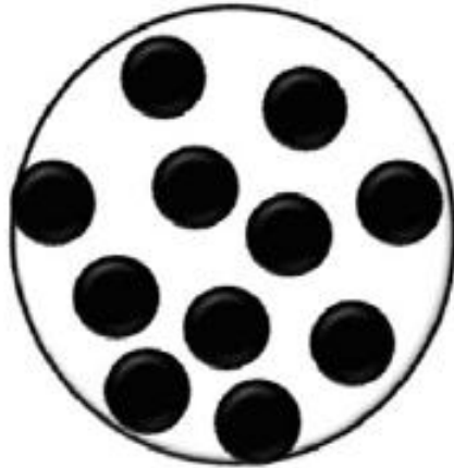
Şekil 2.14. Polimerik küre içerisinde homojen dağılmış manyetik partiküller [6]
