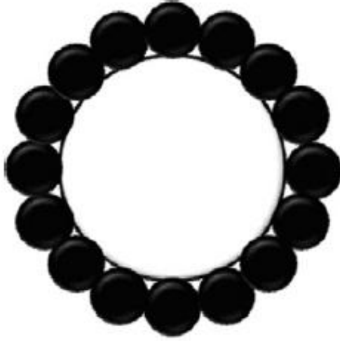
Şekil 2.11. Polimer çekirdek – manyetik kabuk yapısı [6]
