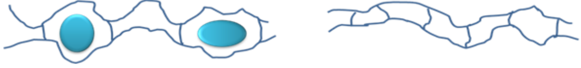
Şekil 4.21. Atrazin baskılı (MIP) ve kontrol polimerlerinde serbest hacimli boşluk oluşumunun şematik gösterimi.
