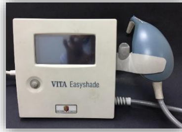
Resim 3.7. Vita Easy Shade Spektrofotometre
