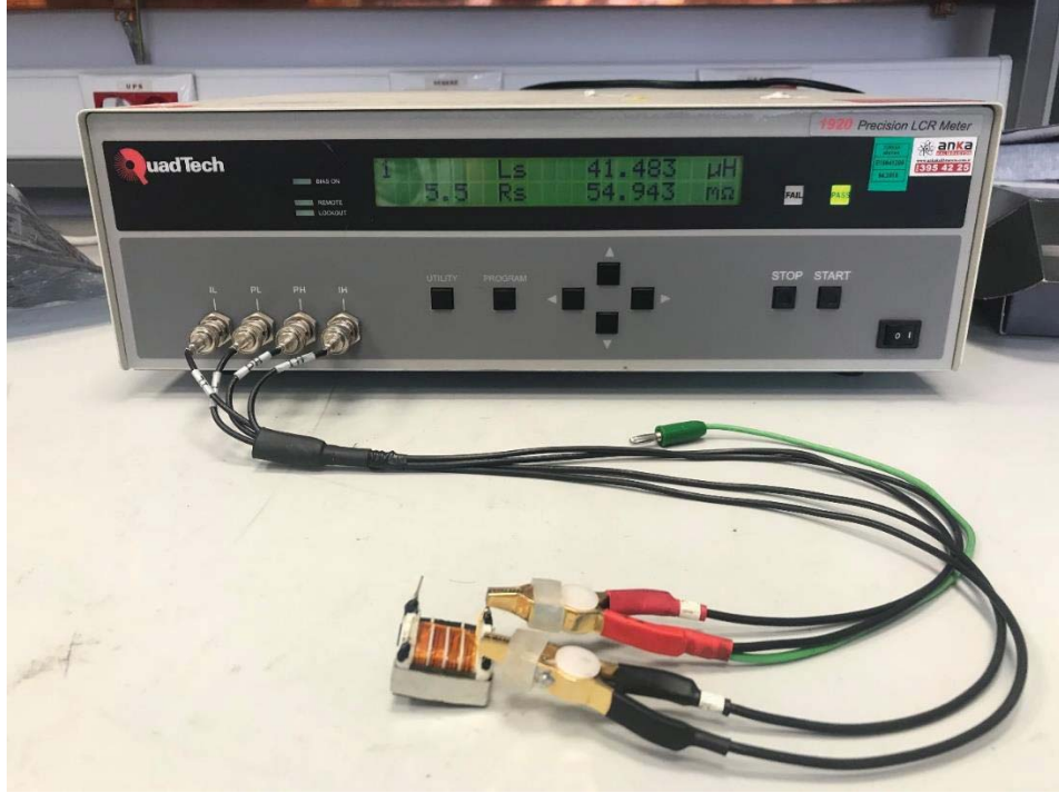
Şekil 5.2. Tasarlanan transformatörü parametrelerinin ölçüm düzeneği.
