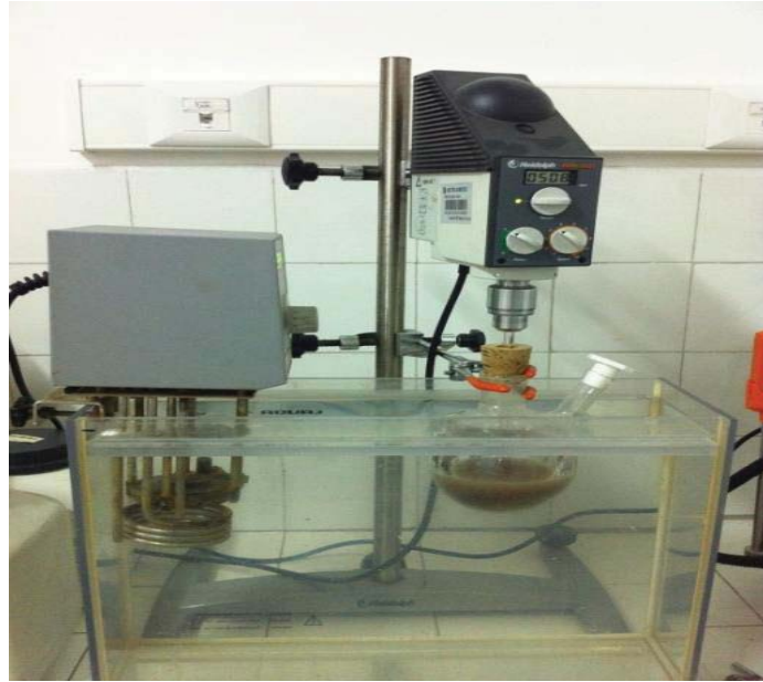
Şekil 3.1. mPHEMA nanokürelerin hazırlanmasında kullanılan miniemülsiyon polimerizasyon düzeneğinin şematik gösterimi.
