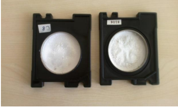
Şekil 4.7. Orantılı sayaçlarda 210 Pb ölçümü yapılmak üzere hazırlanmış numunenin sayım öncesi görüntüsü.
