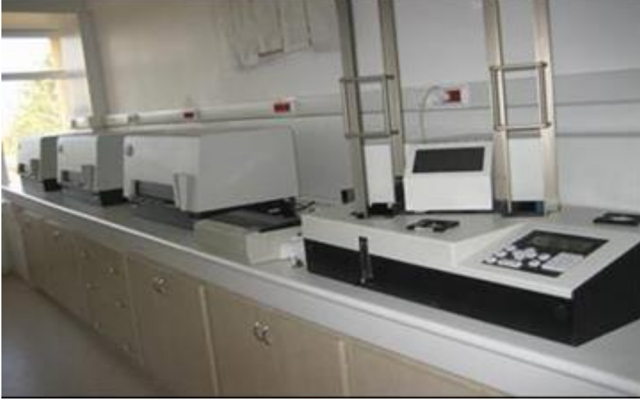
Şekil 3.4. PIC WPC 9550 model otomatik ve PIC MPC 9604 model çoklu detektörlü olmak üzere iki ayrı düşük zemin sayımlı alfa/beta sayım sistemi.
