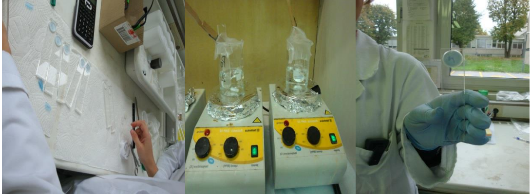
Şekil 4.4. Disk tutucular ve ^{210}\text{Po} 'nun gümüş disk yüzeyine adsorpsiyonu.
